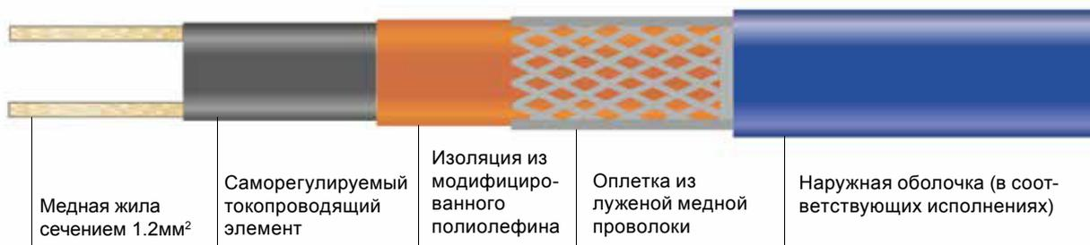
Параллельная конструкция ленты позволяет отрезать ленту нужной длины непосредственно на объекте, при этом операции по заделке выводов и сращиванию осуществляются на месте, без предварительных расчетов. Отсутствует риск перегрева или перегорания ленты при саморесечении или при прохождении ленты через слой теплоизоляции. Тепловыделение ленты саморегулируется в ответ на изменение её температуры.
