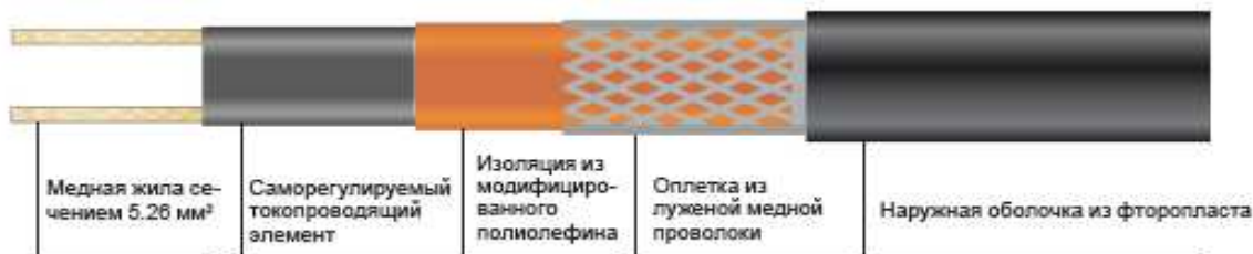
Рис. №1 – конструкция саморегулирующейся нагревательной ленты HLE
